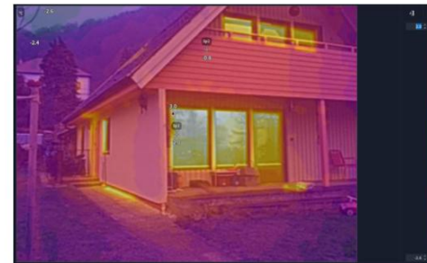
Abbildung 3 Thermografieaufnahme thermische Schwachstellen © IBO
